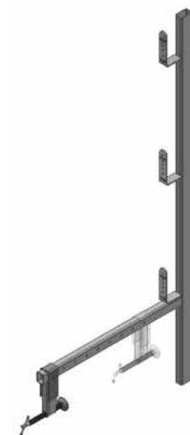
*Fig. 9.1.2.1.1-2* Parapetto provvisorio ammortato con ganascia regolabile
