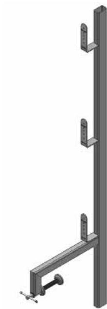
*Fig. 9.1.2.1.1-1* Parapetto provvisorio ammortato con ganascia fissa
