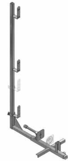
*Fig. 9.1.2.2-1* Parapetto provvisorio per elementi strutturali in legno - fissaggio laterale
