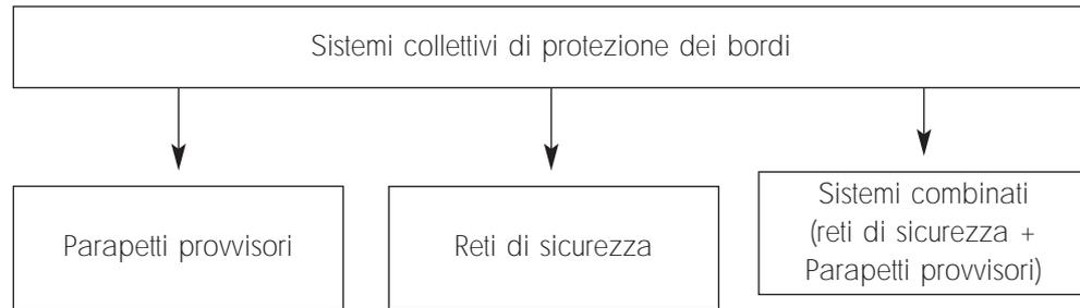
*Fig. 5.1-1* Classificazione dei sistemi collettivi di protezione dei bordi per tipologia
